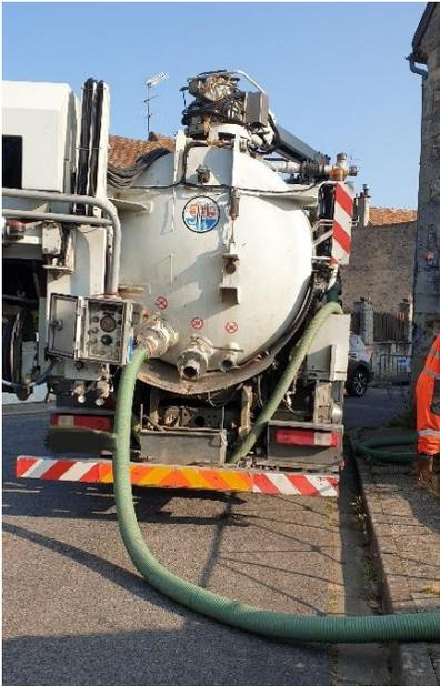
Intervention sous le pont par camion aspirant les matières compactes faisant barrage à l'écoulement de l'eau.
