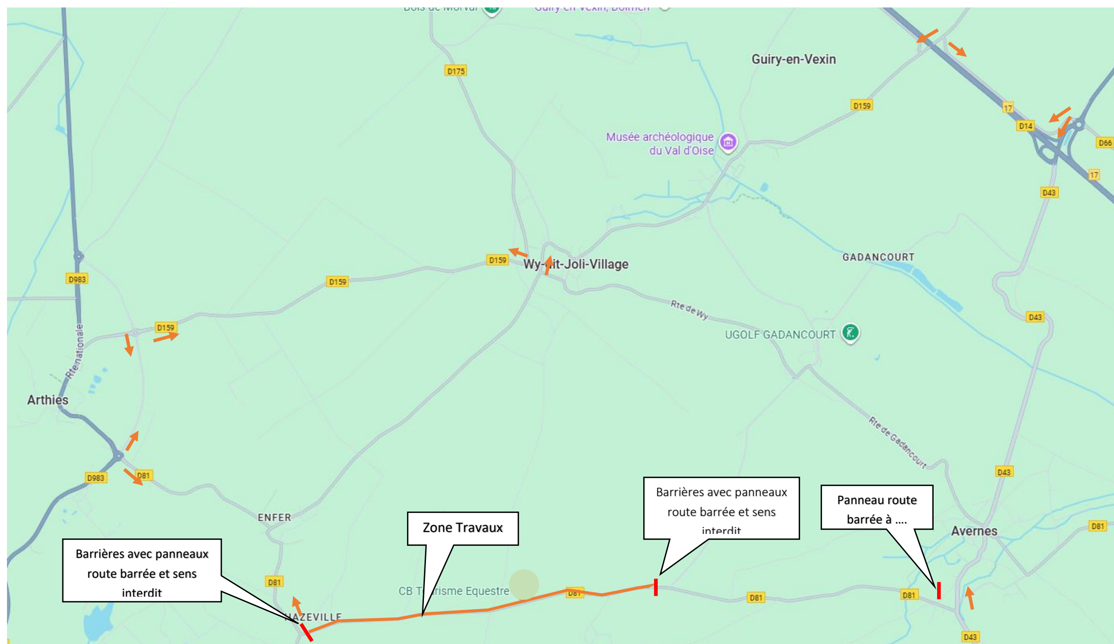
Réfection de la couche de roulement du PR2+100 au PR4+395
